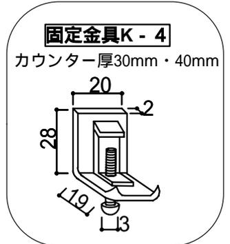
3. シンクのふちの取り付け部分に取付金具を引っ掛ける
