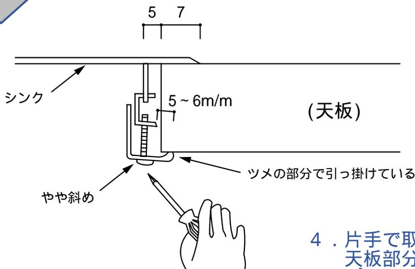
4. 片手で取付け金具を抑えながら、天板部分を金具のツメで引っ掛け、プラスのドライバーでネジを締める
