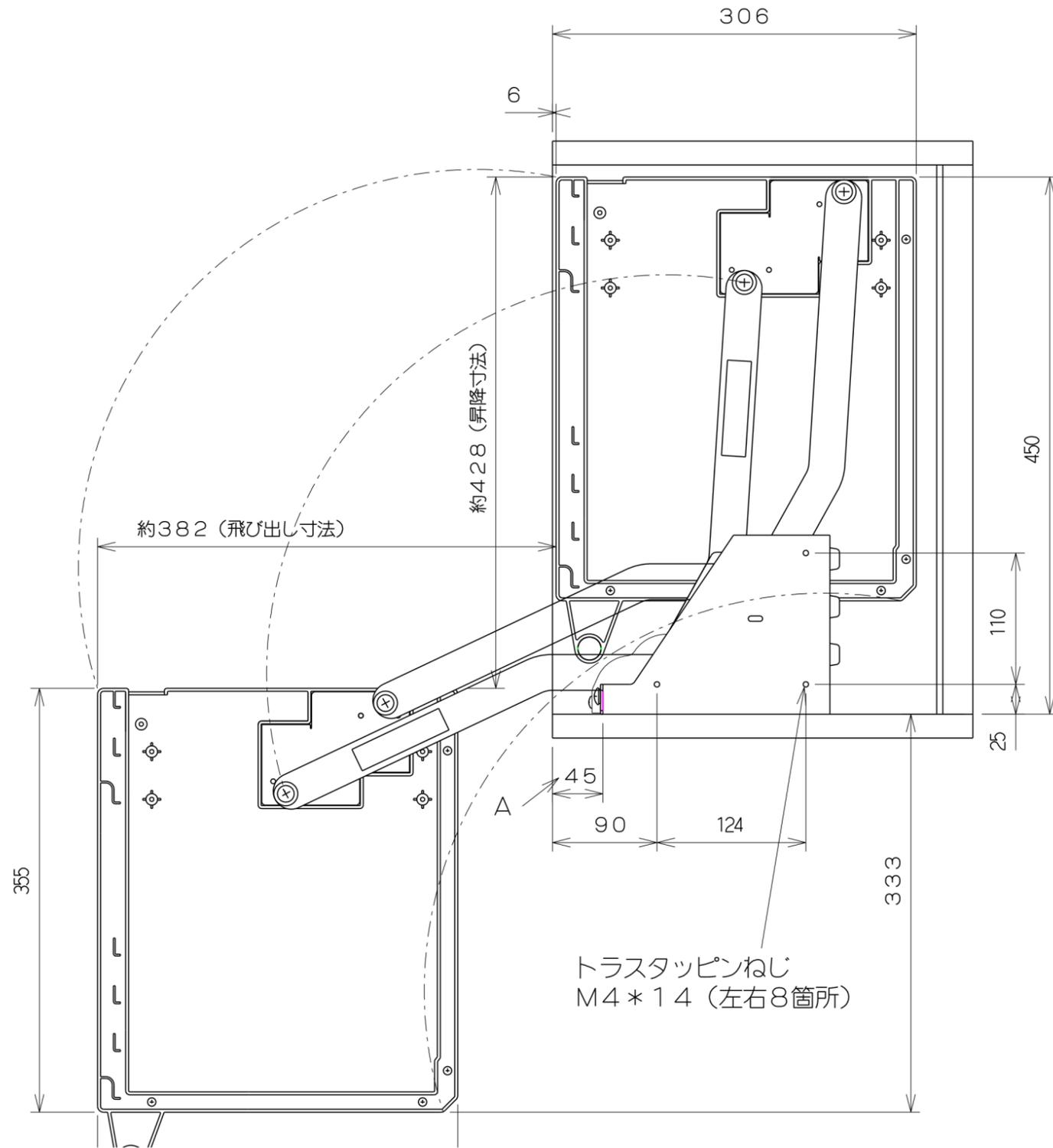
\*寸法Aは固定金具外（ブラケット）とキャビネット前面からの距離（取付け寸法）を表す。
