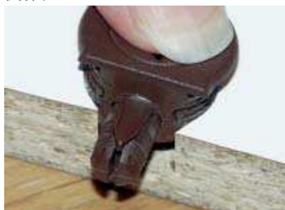
1. ケーシングを下穴に押し込みます。
