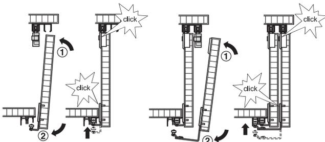
① 上部をクリップ固定し、② 下部を持ち上げてレールの溝に押し込み
