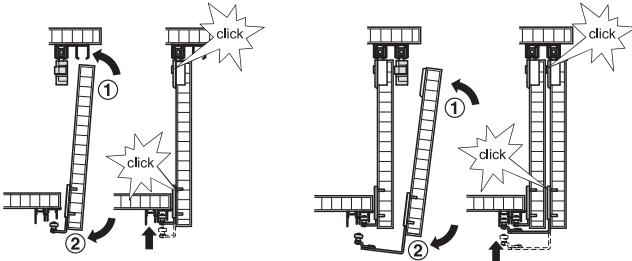
① 上部をクリップ固定し、② 下部を持ち上げてレールの溝に押し込み
